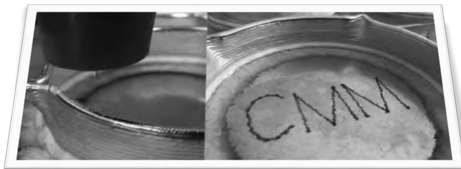
Fig.3. Scrumieră realizată prin fabricație aditivă
