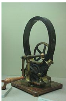
Fig.5. (Model pentru laborator al generatorului electric proiectat de Zénobe Gramme în 1871)
