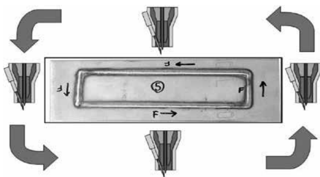
Figura 4. Deplasarea capului pentru sudare în orice direcție fără a se modifica poziția sârmei
